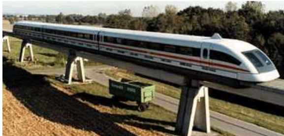
Magnetbahn Versuchsstrecke im Emsland
